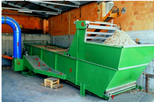
Obr. 3. Fluidní pásová hrabicová sušárna a úsek přípravy paliva
