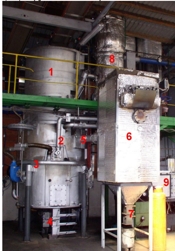
Obr. 4. Souprůdý zplyňovací generátor GP300 s horkým filtrem pro odstraňování TZL
